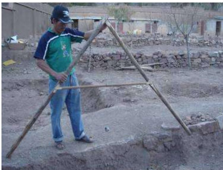
un travesaño se clava a la mitad de los dos palos de tal manera que la distancia entre las dos patas del aparato sea exactamente de uno o de dos metros.
