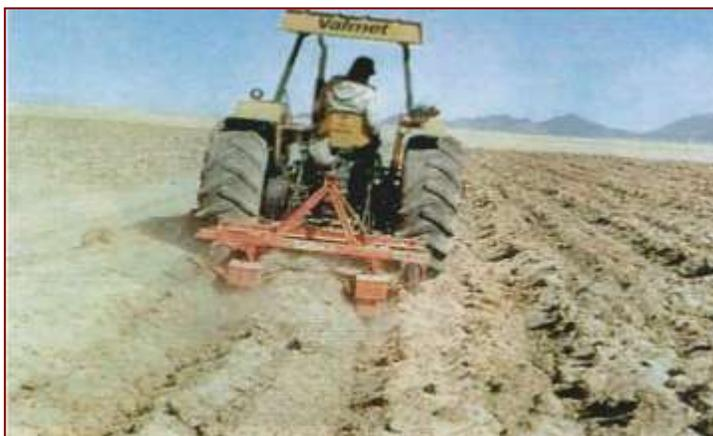
Primeramente, entró en la zona el llamado **Satiri I** que se compone de un surcador, tolvas para la semilla montada en un chasis para ser arrastrado por un tractor. En la siembra abre dos surcos paralelos, donde la semilla es depositada por golpe a una distancia de 0.80 a 1.00 ms. y los surcos están a distancia de 0.80 metros.
